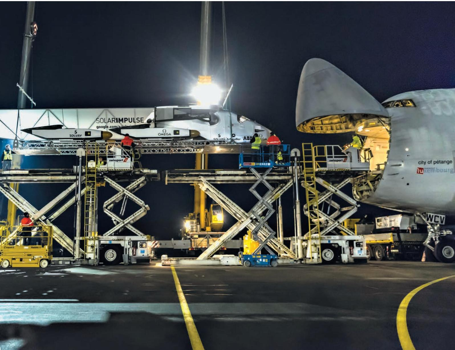
**Le saviez-vous ?** Cargolux a assuré le transport du Solar Impulse. L'avion solaire expérimental à longue portée a été démonté et chargé dans le nez d'un Boeing 747 de Cargolux avant d'entamer son vol pionnier autour du monde à partir d'Abu Dhabi en mars 2015.
