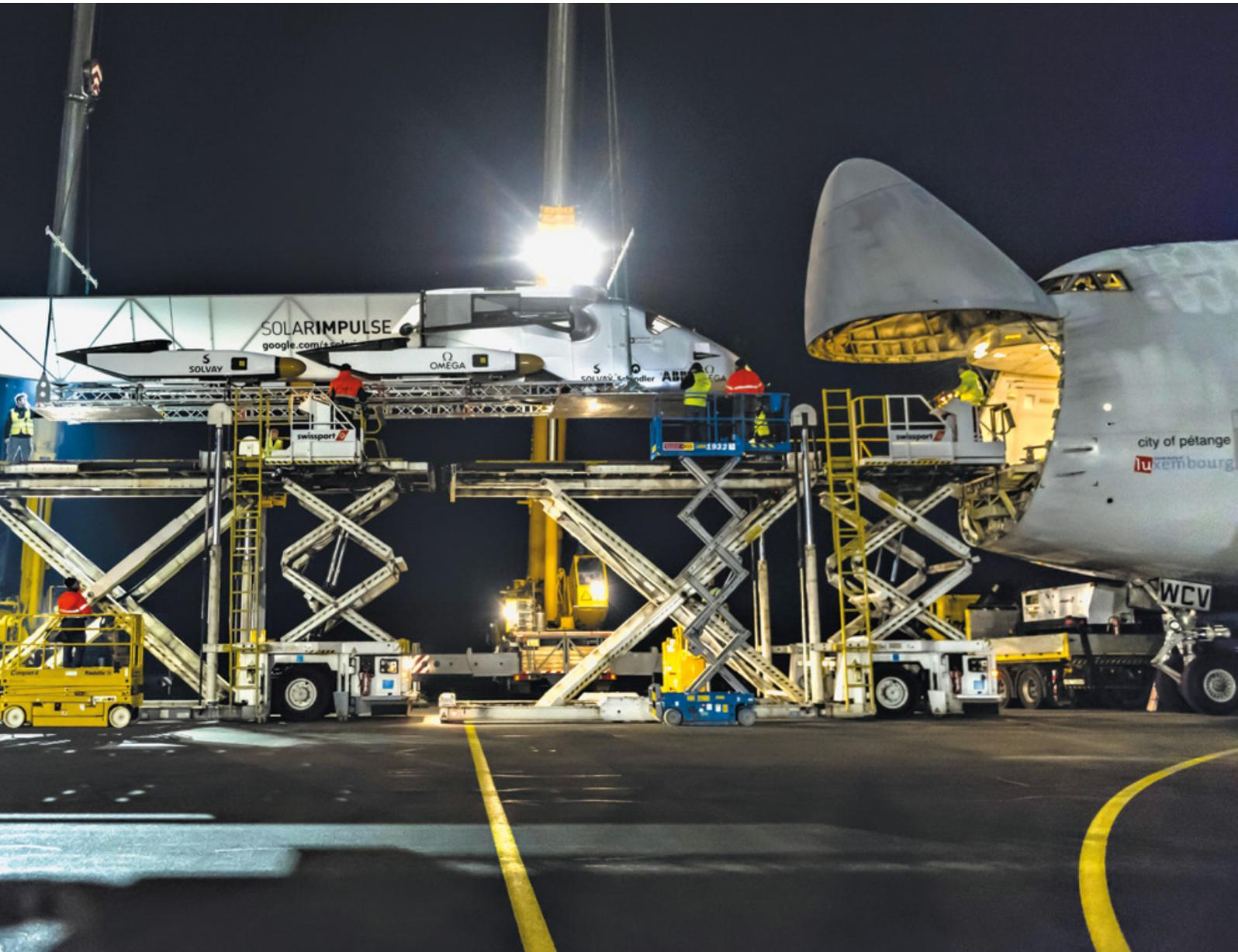
**Wussten Sie ...** dass Cargolux für den Transport der Solar Impulse gesorgt hat? Das experimentelle, solarbetriebene Langstreckenflugzeug wurde demontiert und in die Nase einer Cargolux Boeing 747 geladen, um im März 2015 in Abu Dhabi zu seiner aufsehenerregenden Weltumrundung aufzusteigen.
